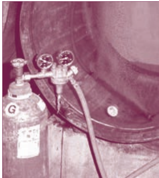
სურათი 8.74. ნახშირმჟავას გამოდევნა აზოტით
