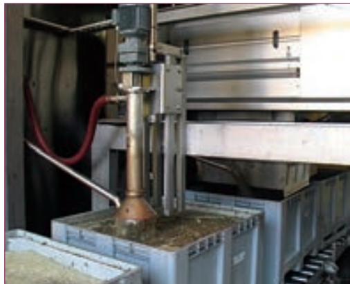
სურათი 8.13ა. წვენის სინჯის ავტომატიზებული აღება
